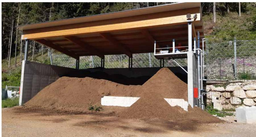
**Foto 6 - Frazione solida separata dal resto del refluo in uscita dopo la produzione di biogas**
