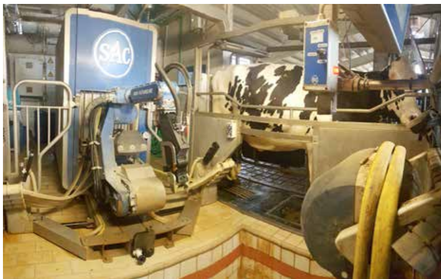
Il robot SAC con in primo piano il braccio che serve per attaccare i gruppi di mungitura
