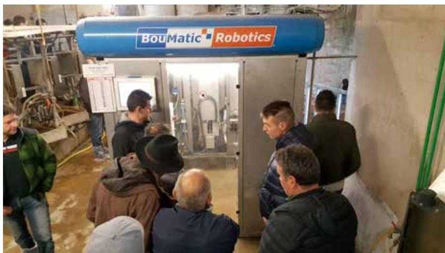
Il robot della BouMatic attacca il gruppo di mungitura da dietro
