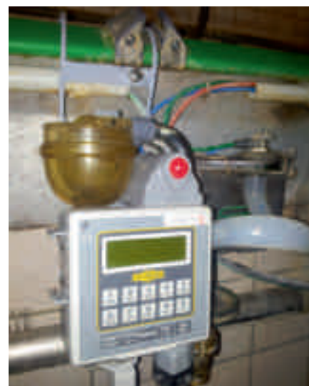
Figura 1. Lactocorder: lo strumento viene installato a valle del tubo lungo del latte prima del lattometro.
