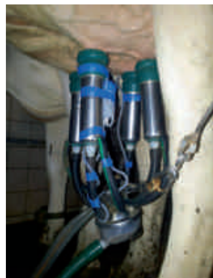
Figura 4: lo strumento Vadia installato su un gruppo di mungitura
